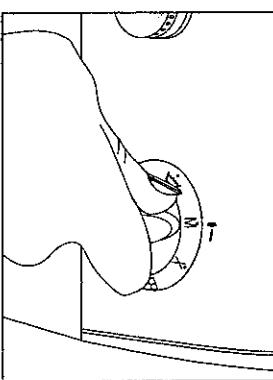
Sıcaklık ayar düğmesini çevirerek istediğiniz sıcaklığı seçiniz. Sıcaklık ayar düğmesi "I" konumundayken musluk suyu sıcaklığı ile yukarı yapıılır. Kullanmanız gereken yardımcı fonksiyon tuşlarına basınız.
